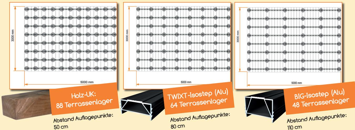
Durch den Einsatz einer Aluminium-Unterkonstruktion können bis zu 40 Terrassenlager eingespart werden!
