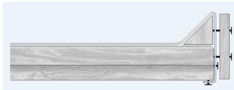
Ortgang mit Holzkeil und Windbrett mechanisch fixiert.
