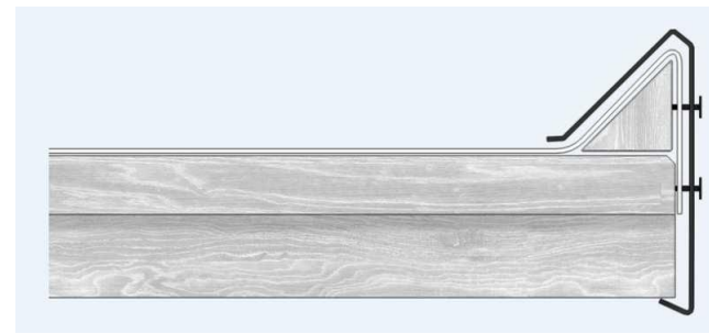
Ortgang mit Holzkeil und Metallabdeckung mechanisch fixiert.
