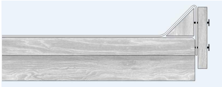
Ortgang mit Holzkeil und Windbrett mechanisch fixiert.
