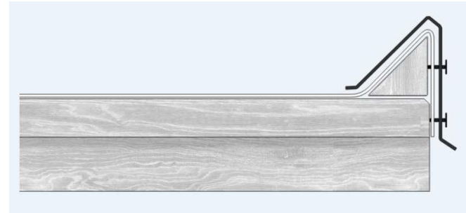
Ortgang mit Holzkeil und Metallabdeckung mechanisch fixiert.
