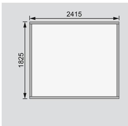
Fundamentplan mit Boden (in mm)
