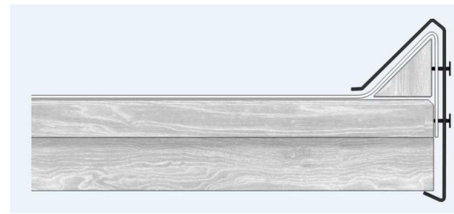
Ortgang mit Holzkeil und Metallabdeckung mechanisch fixiert.
