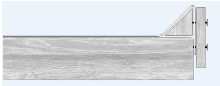
Ortgang mit Holzkeil und Windbrett mechanisch fixiert.
