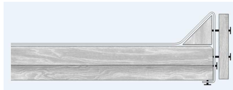
Ortgang mit Holzkeil und Windbrett mechanisch fixiert.
