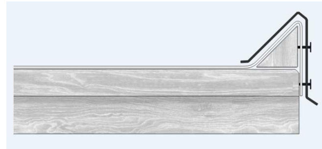
Ortgang mit Holzkeil und Metallabdeckung mechanisch fixiert.
