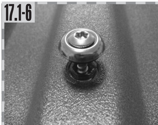
17.1-6 ... und mit demselben Torx 20-Bit einschrauben...
