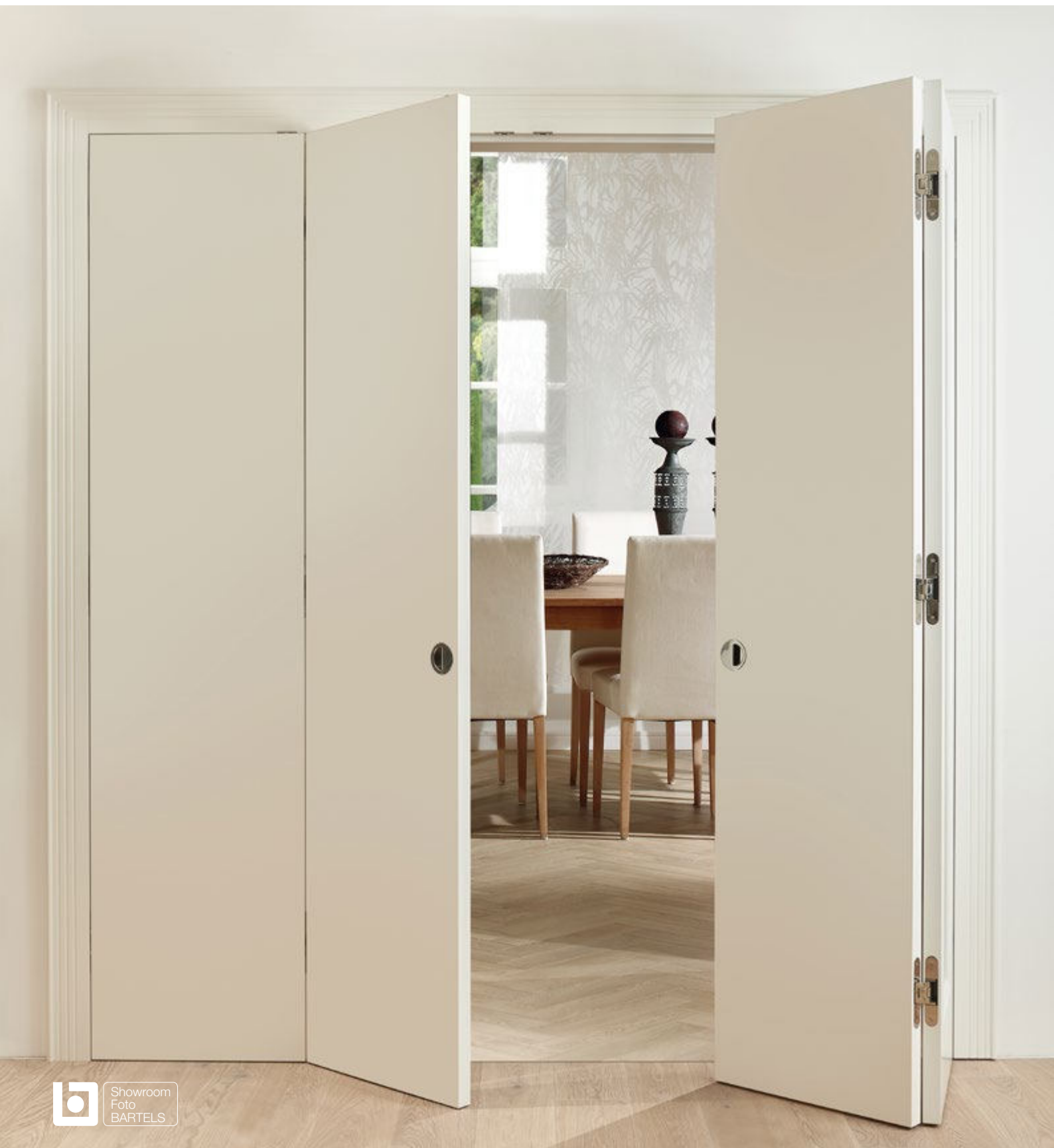
4-teilige Falanlage, ohne Schlösser, mit Rollenschnäppern und flächenbündig eingelassenen Griffmuscheln | Bekleidung R112
