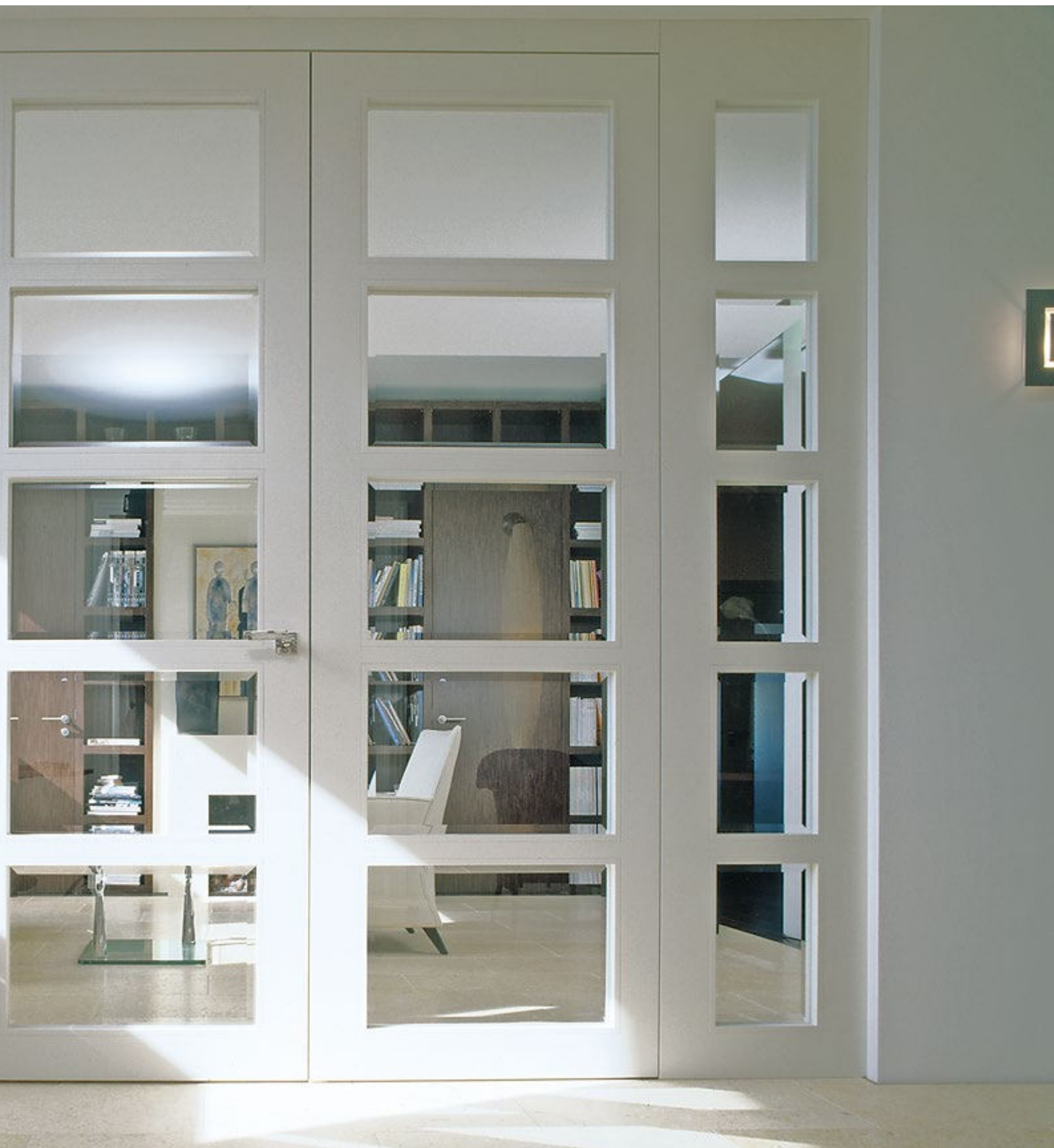
Türblatt Typ G5.1 mit Verglasung | Q-Profil | Ausführung stumpf | Blendrahmen | Schleiflack weiß RAL 9016
