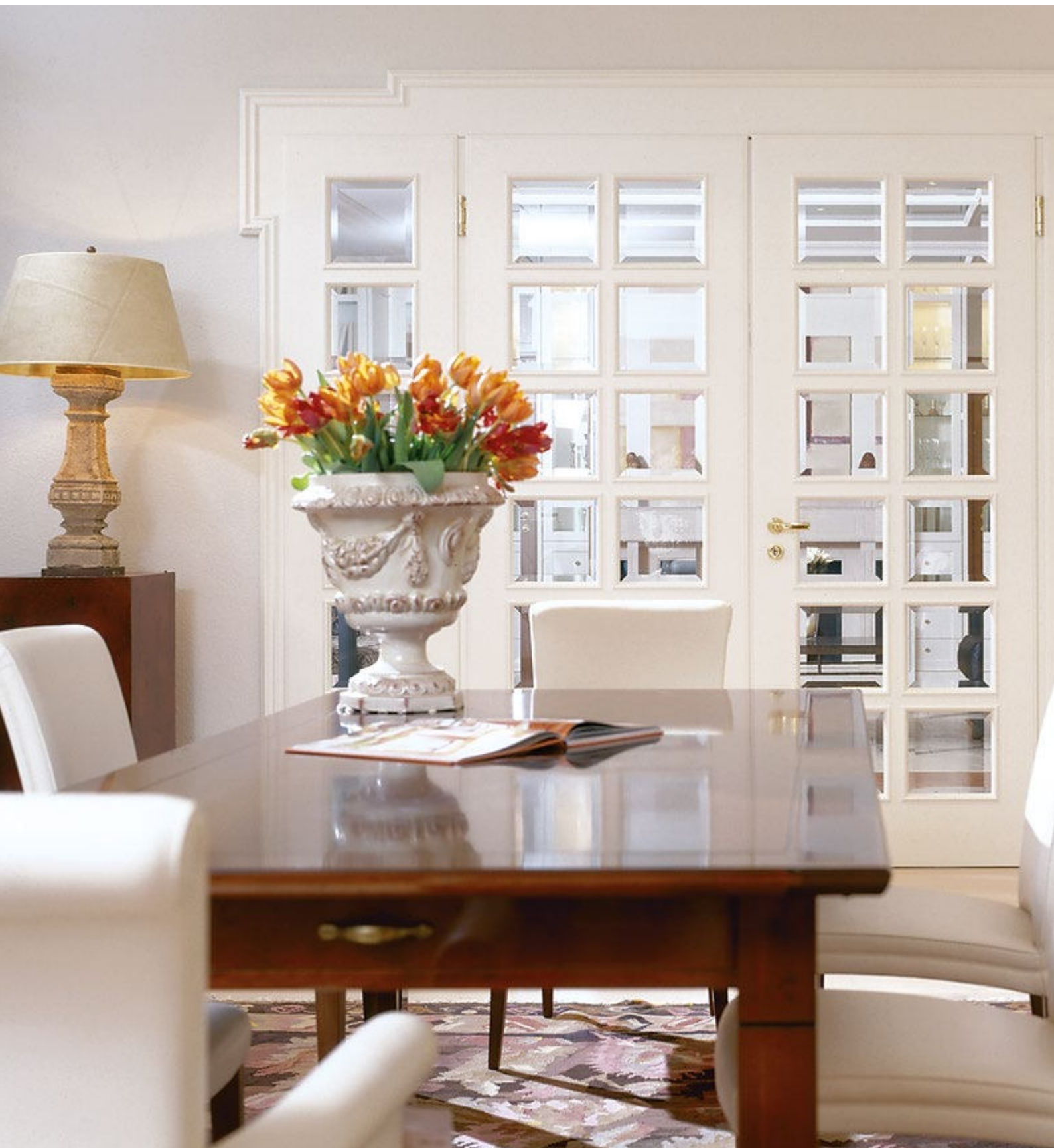
Türblatt Typ G12 mit Verglasung | Sonder-Profile und Klarglas mit Facette | Zarge MG95 mit Auskrägungen und Basenklotz | Schleiflack weiß RAL 9016
