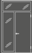
1-flügelig mit einem Seitenteil, u. Oberlicht
