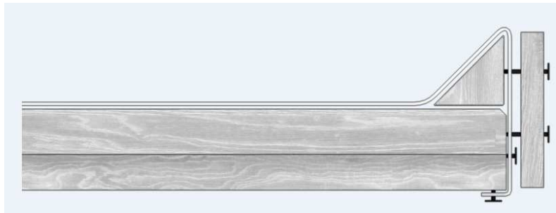
Ortgang mit Holzkeil und Windbrett mechanisch fixiert.
