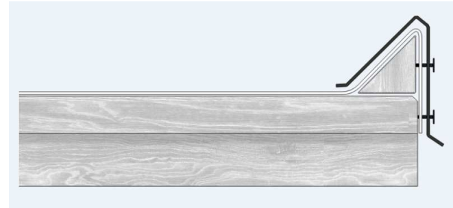
Ortgang mit Holzkeil und Metallabdeckung mechanisch fixiert.
