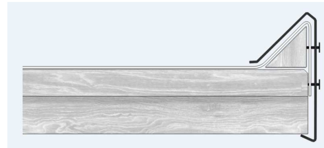
Ortgang mit Holzkeil und Metallabdeckung mechanisch fixiert.
