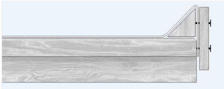
Ortgang mit Holzkeil und Windbrett mechanisch fixiert.
