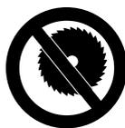
Niemals Kreissägeblätter, Hartmetall-, Bergungs-, Holzschneide- oder andere verzahnte Werkzeuge verwenden – **Gefahr tödlicher Verletzungen!** Im Gegensatz zum gleichmäßigen Abtragen von Partikeln bei Benutzung von Trennschleifscheiben, können die Zähne eines Kreissägeblattes beim Schneiden in den Werkstoff einhaken. Dies bewirkt ein aggressives Schneidverhalten und kann zu unkontrollierten, äußerst gefährlichen Reaktionskräften (Hochschlagen) des Gerätes führen.
