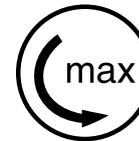
Die zulässige Drehzahl der Trennschleifscheibe muss gleich hoch oder höher sein als die maximale Spindeldrehzahl des Trennschleifers! – siehe Kapitel "Technische Daten".
