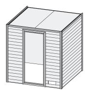
10 cm Wand- und Deckenabstand beim Aufbau einhalten! Aufbau mit und ohne Dachkranz möglich.
